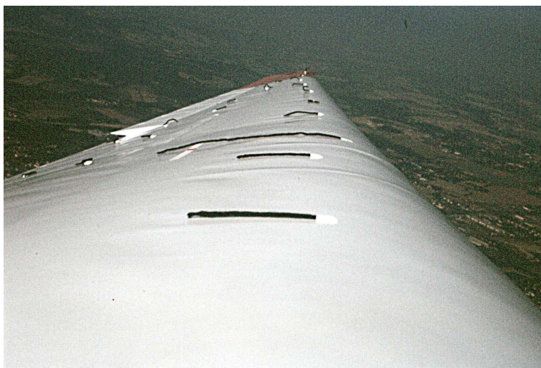
Bild 6. Beginnender Strömungsabriß an der nachgeschobenen Tragflügelhälfte beim Einleiten des Linkstrudelns, Schieben nach rechts (nach außen)
