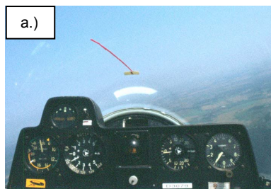
Bild 4. Flugbahnkrümmung nach rechts, a.) Schieben nach innen; b.) Schieben nach außen
