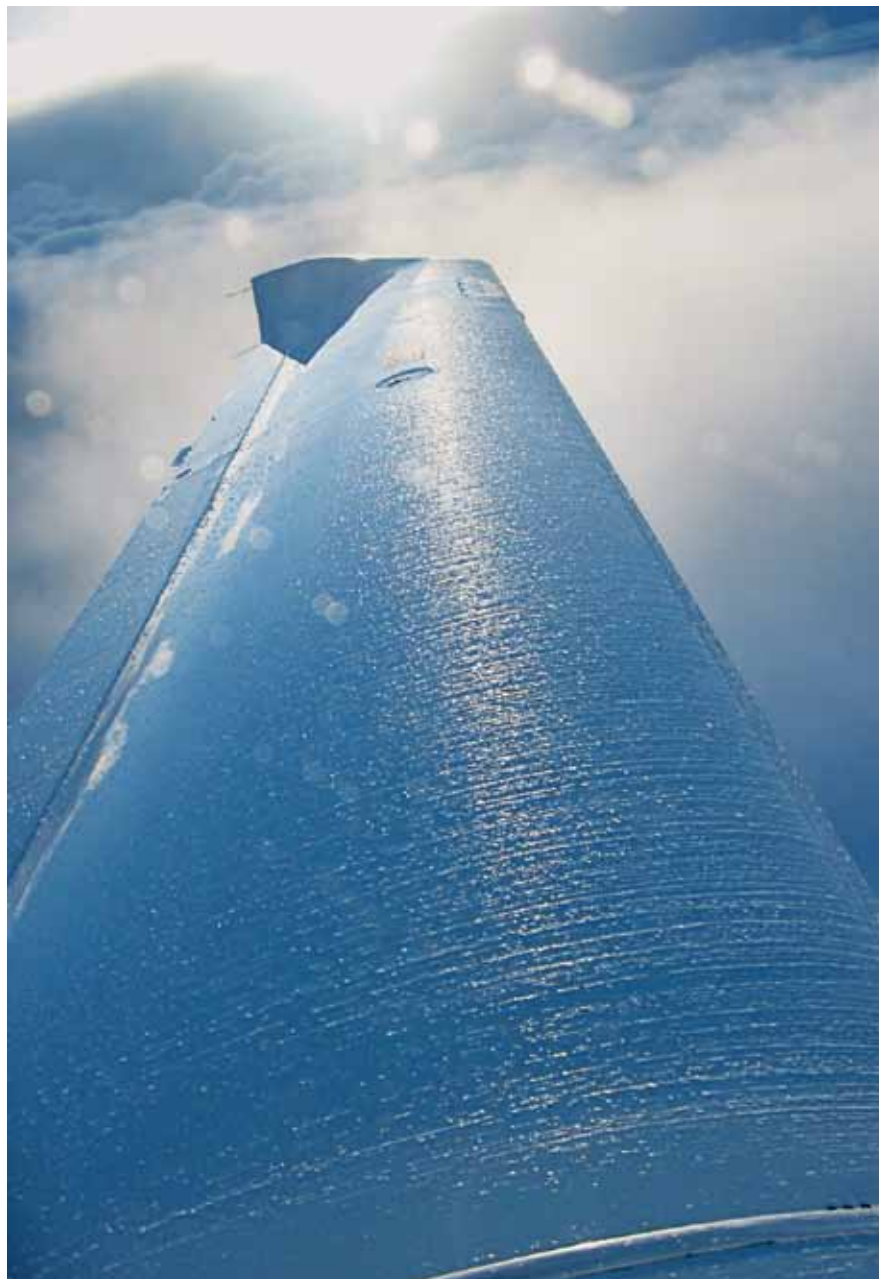
So „dramatisch“ kann die Vereisung einer Tragfläche aussehen
